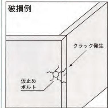
上図の様にボルトだけの固定及び、他の接着剤使用ですとボルト連結部よりクラックが入り、破損する事があります。必ずセラチャックを使用してください。
